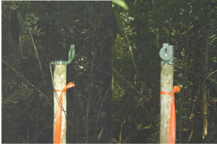
Figura 7. Vista de la posición que debe tener la brújula al momento de comenzar a instalar la parcela permanente de muestreo. Fuente: Proyecto Inventario Florístico de la Región Madidi (2005).
